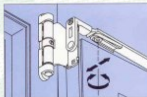
Viršutinio kampo nuo vyro pusės prispaudimo reguliavimas.
