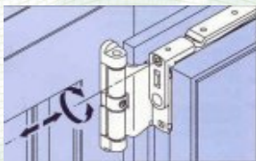
Viršutinės varčios dalies reguliavimas kairėn ir dešinėn.
